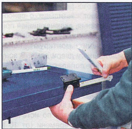
Для соединения створок ставня используют петли. Сначала размечают положение петель.
