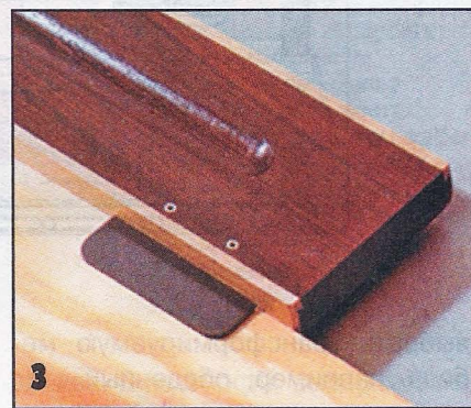
3 На упоре больших угольников длиной более 600 мм на уровне стальной линейки имеется металлический опорный язычок, придающий угольнику устойчивость при измерениях.
