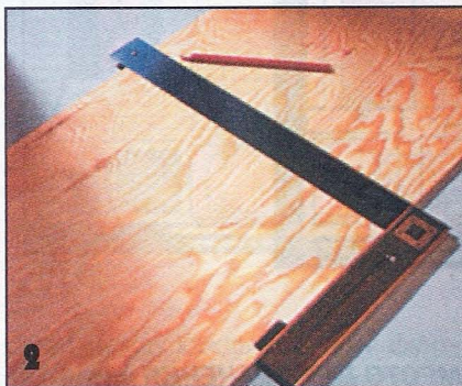
2 При разметке широких заготовок пользуются угольником с длинной линейкой. Разметить такие заготовки можно и с помощью короткого угольника. В этом случае обозначенную линию можно продолжить обычной линейкой.
